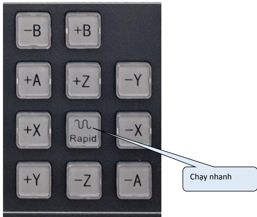
Hình 1.8: Các phím trên bảng điều khiển của tủ điều khiển máy phay CNC.
