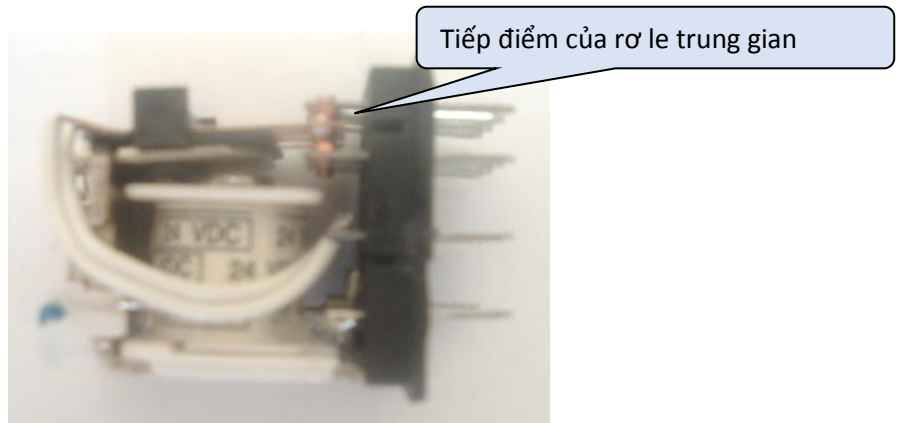
Hình 11.6: Kiểm tra rơ le trung gian.
